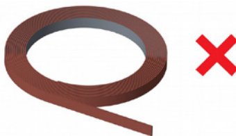
Magnetische Seite nach außen gewickelt
