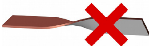
Magnetische Seite nach innen gewickelt
